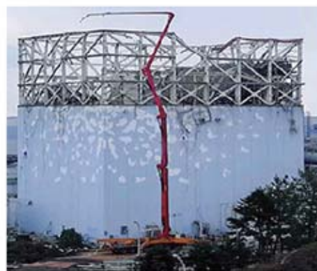
東日本大震災後の福島原発で大活躍、62m アームポンプ車 中国『三一重工 (SANY)』社製『大麒麟』SY5502THB
